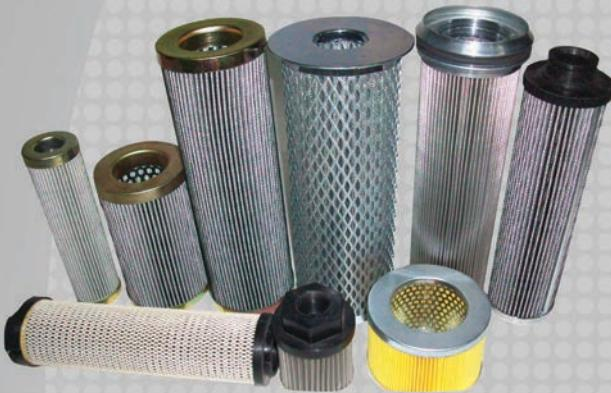
Hidrolik filtreler sanayinin her alanında yaygın kullanılan birçok makinada ve basınç hatlarında emiş ve dönüş hatlarında yaygın kullanım alanı olan 3 mikrondan 50 mikrona kadar üretilen krom meş tellerden de üretilebilen uzun ömürlü bypasslı filtrelerdir. Firmamız özel imalatlarda çözüm ortağınız olabilir.
